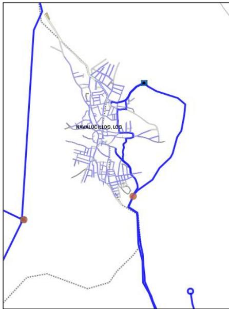
Desde esta potabilizadora se abastece con una tubería de 160 mm de diámetro de PVC al citado depósito general, y desde. Desde el depósito se conduce hacia el citado núcleo con una tubería de 160 mm de diámetro de PVC y una longitud de 1.978 metros. El depósito se encuentra en la parcela 164 del polígono 11 del catastro de rústica que cuenta con una superficie de 1.218 m<sup>2</sup>., cuyo emplazamiento se puede ver en la imagen adjunta.
